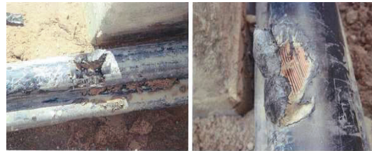
ภาพแสดงความเสียหายที่ปลอกสาย Cable 11.5KV ที่ Foundation #A41
